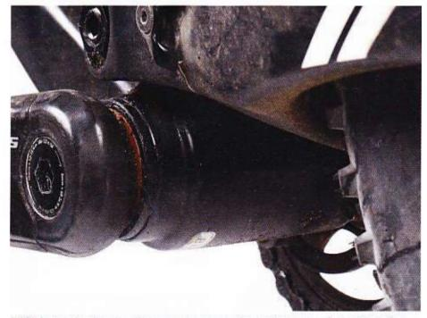
Vérifiez ensuite chaque point en contact avec des équipements afin de déterminer qu'il n'y a pas d'amorces de fissures (boîte de pédalier, tube de selle, tube de direction, patte arrière...)
