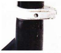
Regardez si la matière du cadre n'a pas été déformée par un couple de serrage non conforme : un collier de tige de selle trop serré par exemple ou encore une vis trop longue d'étrier de frein en PostMount.
