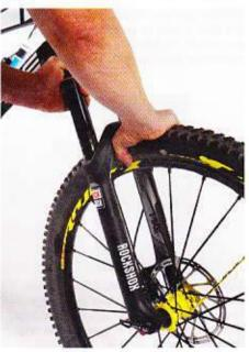
Vérifiez l'état des roues en les faisant tourner manuellement. Ca gratte ? Les roulements sont fatigués. Le moyeu claque en latéral. Il y a un voile sur la jante ? Vérifiez manuellement la tension des rayons en les prenant deux par deux. Si les roulements grattent, que la tension de rayon n'est pas uniforme et/ou que l'un ou les moyeux ont du jeu, faites baisser la facture. Attention, un pneu mal monté peut créer l'illusion d'un voile de roue.
