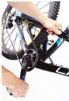
Contrôlez si les manivelles présentent un jeu au niveau du boîtier de pédalier : si un mouvement latéral d'une manivelle occasionne un claquement, le boîtier de pédalier est à changer ou les vis sont desserrées.
