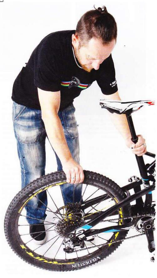
Vérifiez chaque point d'articulation pour les tout-suspendus pour s'assurer qu'il n'y a pas de jeu latéral. Prendre la roue arrière d'une main et de l'autre maintenir la selle, puis ramener et pousser la roue arrière. Ce test permettra aussi de voir si la roue arrière présente un jeu.
