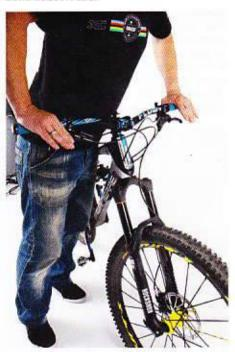
Vérifiez que les suspensions fonctionnent en compression sur les différents modes proposés (ouverte, semi-bloquée ou fermée) ainsi qu'en détente.
